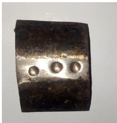
Gambar 4. 9 pesimen yang mendapatkan perlakuan uji kekerasan brinell
