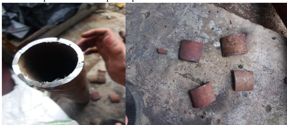
Gambar 3. 2 hasil pemotongan pipa standar menjadi lebih kecil
