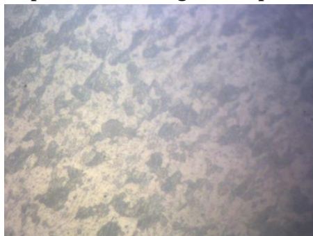
Gambar 4. 5 specimen A menggunakan pembesaran 500x
