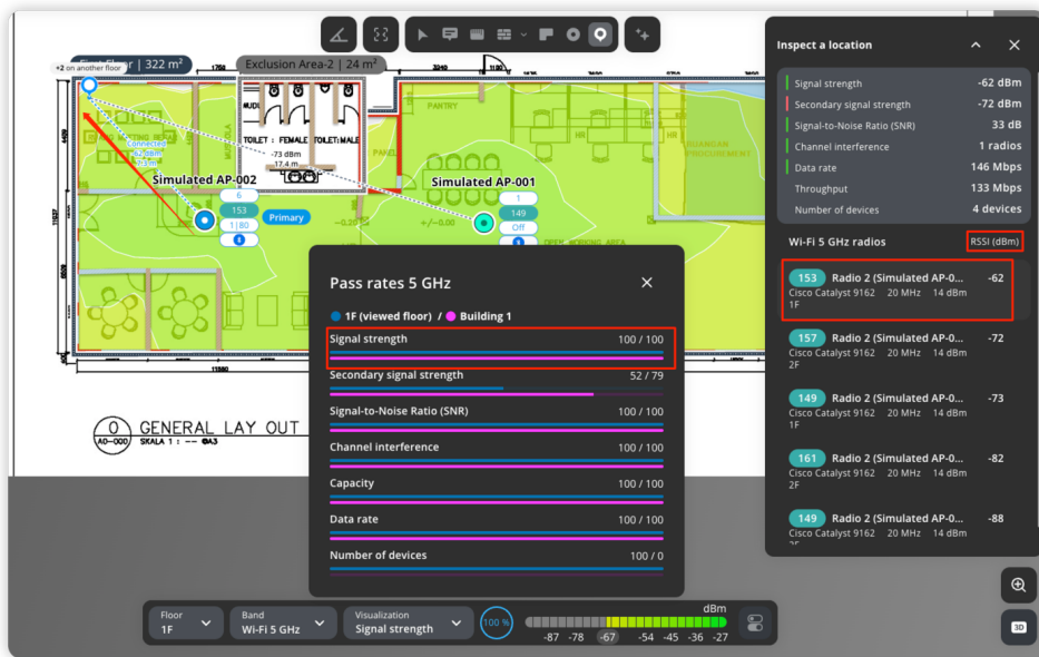
Gambar 16. Pass Rates Desain Optimal 5 GHz Sumber: Hasil simulasi penulis menggunakan Ekahau AI Pro.
